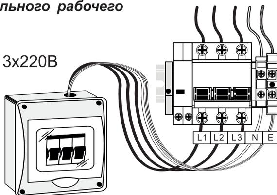
В случае однофазного подключения электродкотла необходимо специальной перемычкой (1), (входит в комплект поставки), замкнуть на клеммной колодке фазные контакты, помеченные как L1, L2 и L3 и тщательно протянуть винты. После этого можно подсоединить фазный проводник на любой из трёх контактов L1, L2, или L3, нулевой проводник на контакт N, и заземление на контакт E.
