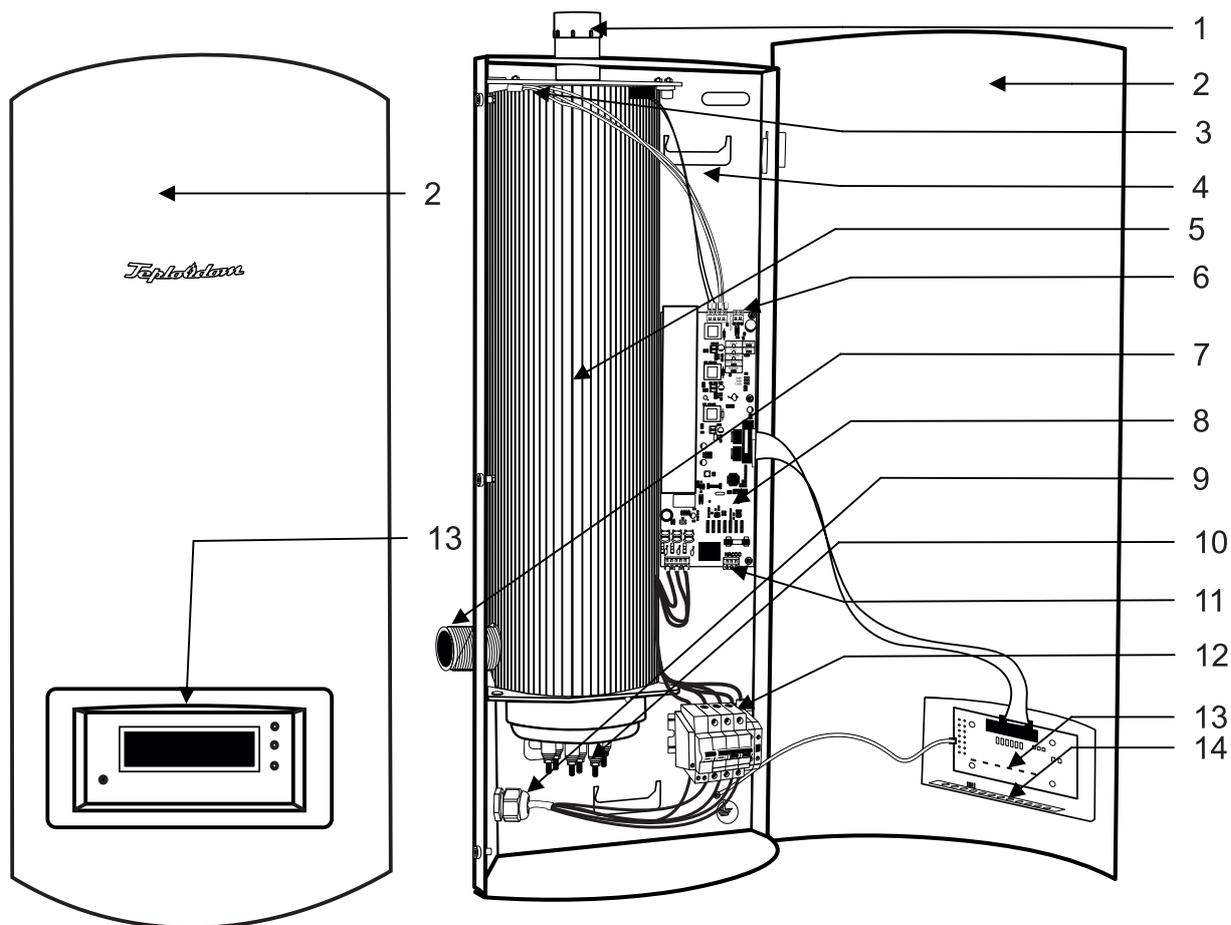
1 - выходной патрубок; 2 - лицевая панель; 3 - термодатчик; 4 - крепление к монтажной планке; 5 - теплообменник с ТЭНами в теплоизоляции; 6 - колодка для подключения термостата; 7 - входной патрубок; 8 - плата управления; 9 - гермоввод электропитания; 10 - блок ТЭНов; 11 - колодка для подключения циркуляционного насоса; 12 - Расцепитель, вводной автомат и колодки подключения (ноль N, земля E); 13 - панель управления с дисплеем; 14 - светодиодная подсветка.
